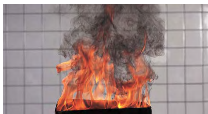
Feu de test 5: Feu liquide (n-heptane)
